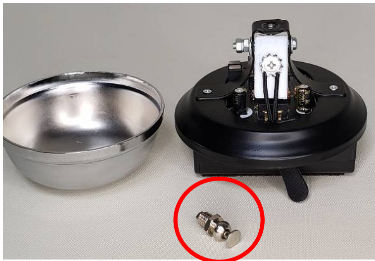
写真 3-8 鐘の取り外し写真（正面）
