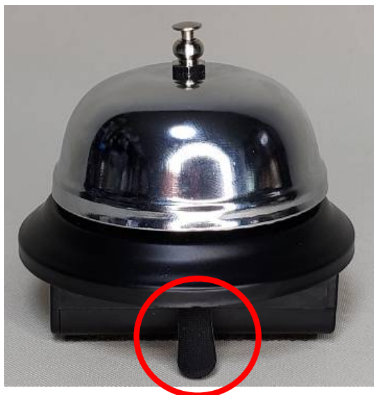
写真 3-7 音源選択切り替え紐スイッチ部分の写真 (背面)
