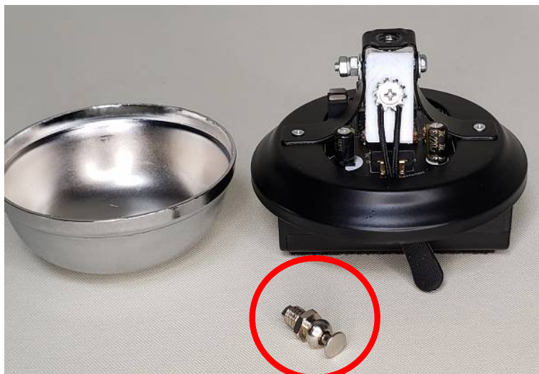
写真 5-1 鐘の取り外し写真 (正面)
