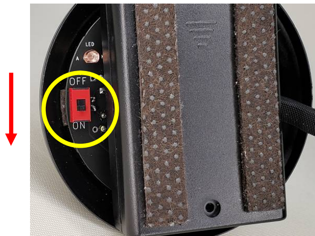
写真 3-5 電源スイッチと LED の部分の写真 (底面)
